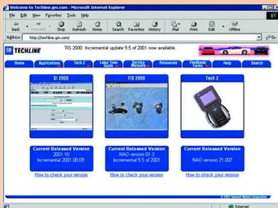
Bei Problemen mit Software-Produkten der GM Service-Abteilung steht nun eine Internet-Seite zur Verfügung: Techline.gm.com. Abgedeckt werden die Fahrzeug-Programmierung und -Diagnose mit TIS 2000, SI 2000 und Tech2, sowie die Arbeitszeiten.
