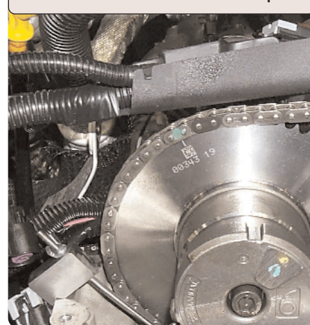
Outil de maintien de chaîne J-44217 en place
