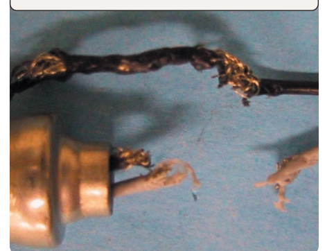
Gerissenes Kabel durch Verwendung des falschen Schlüssels
