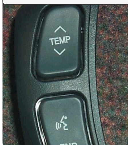
Sprachsteuerungstaste am Lenkrad
