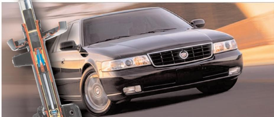
Le modèle 2002 Cadillac Seville STS a été choisi pour introduire une nouvelle technologie de suspension révolutionnaire. Appelé commande magnétique de stabilité (RPO F55), ce système remplacera le système de suspension variable en continu sensible à la route (CVRSS, RPO F45) dès janvier 2002.
