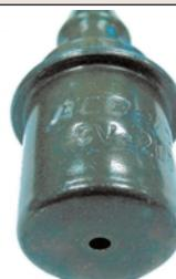
de papillon connaît une augmentation d'admission d'air en raison d'un changement dans le système RGC. La soupape RGC, actuellement variable, sera remplacée par un orifice fixe.
