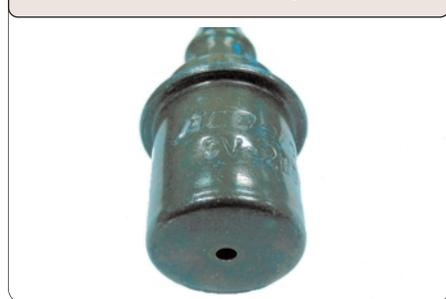
El aire que se envía del cuerpo del estrangulador se empata con el flujo de aire de la válvula PCV. Por tanto no podrán intercambiarse las válvulas PCV y los estranguladores. Para asegurarse de que está usando la válvula correcta y el estrangulador correcto, verifique el número de parte impreso en la esquina inferior derecha del estrangulador y compárelo con el número de parte OE listado en las tablas.
