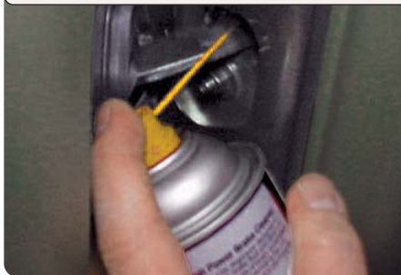
Lubrification de la sellette de biellette de retenue.
