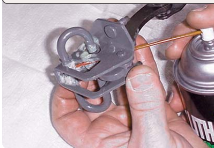
Biellette retirée pour montrer l'endroit à lubrifier.
