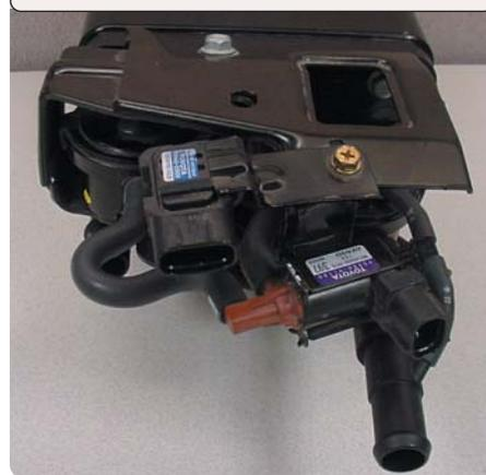
Das Umschaltmagnetventil des EVAP-Systems ist mit einer Schraube an den Aktivkohlebehälter angebaut. Nicht den gesamten Aktivkohlebehälter austauschen. Das PSW kann separat ersetzt werden. Die Teile-Nr. des Ventils lautet 94859365.
