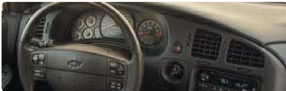
Nach einem Austausch der Instrumententafel beim 2000-2002 Impala und Monte Carlo muss diese mit dem Tech 2 programmiert werden.
