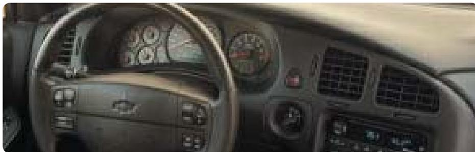
Después de reemplazar el centro de instrumentos en el Impala y Mote Carlo 2000-2002, será necesario reprogramar el panel de instrumentos utilizando el Tech 2.
