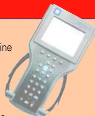
On a découvert que le contrôle au poste de travail de l'EVAP du Tech 2 n'indiquait pas précisément ce qui se passait dans certains véhicules équipés de moteurs V6 et V8 de luxe. Ainsi, pendant un certain temps, le contrôle au poste de travail EVAP est annulé dans le logiciel Tech 2 pour ces véhicules.
