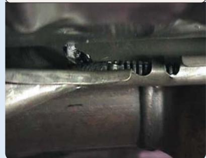
Il faut remplacer les composants endommagés par l'eau. Pour empêcher que le problème ne revienne, raccorder une longueur de boyau de 5/8 de po au coude de drainage du climatiseur. Orienter le boyau vers le bas pour que l'eau s'égoutte de façon appropriée et l'immobiliser à l'aide d'une attache autoblocante.
