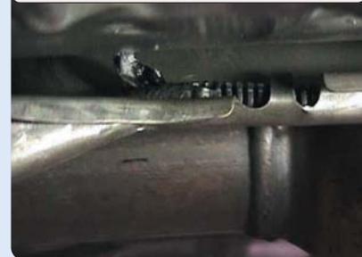
Bauteile mit Wasserschäden müssen ersetzt werden. Um ein erneutes Auftreten des Problems zu verhindern, ein Stück 5/8 Zoll Schlauch auf das Ablaufknie des Verdampfers aufstecken. Schlauch abwärts verlegen, so dass Wasser richtig ablaufen kann; ggf. mit Kabelbindern sichern.
