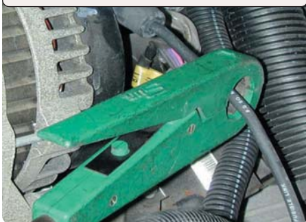
Conexión correcta del probador de corriente al generador
