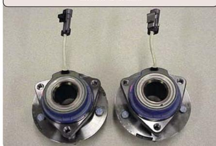
Lorsque vous remplacez un capteur de vitesse de rotation de roue / palier de roue (pour bruit de roulement, code WSS, etc.), il faut déterminer le type de capteur qui équipe le véhicule et remplacer par un dispositif de même nature. Vérifier le livre des pièces pour obtenir des détails.
