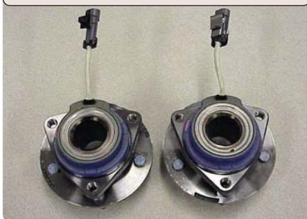
Beim Ersetzen eines Raddrehzahlsensors/ einer Radlagerbaugruppe (wegen Lagergeräuschen, WSS-Code usw.) müssen Sie ermitteln, welcher Sensortyp im Fahrzeug verbaut ist, und diesen durch einen Sensor gleichen Typs ersetzen. Einzelheiten siehe Teilehandbuch.
