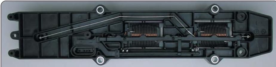
Zerlegte Zündungskassette zur Darstellung der Einzelbauteile
