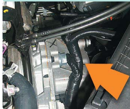
Falsch verlegter Kabelsatz
