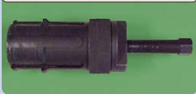
La douille peut être endommagée compte tenu de l'état du cardan ou de l'arbre de transmission. Par le passé, le remplacement de la douille exigeait que l'on dépose la boîte-transfert du véhicule. Le nouvel outil permet d'effectuer la réparation à bord du véhicule. Un bulletin subséquent donnera le détail de la procédure. Voici les faits saillants :
