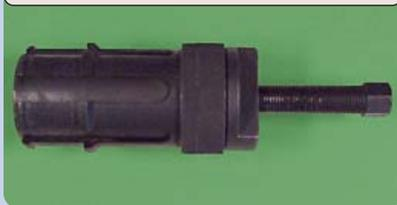
Die Buchse kann aufgrund von Universalgelenk- oder Gelenkwellen-Störungen beschädigt werden. Bislang musste zum Auswechseln der Buchse das Verteilergetriebe ausgebaut werden, was mit dem neuen Werkzeug nicht länger erforderlich ist. Der Arbeitsgang wird in einem noch zu veröffentlichenden Bulletin erläutert. Nachfolgend ein Überblick.
